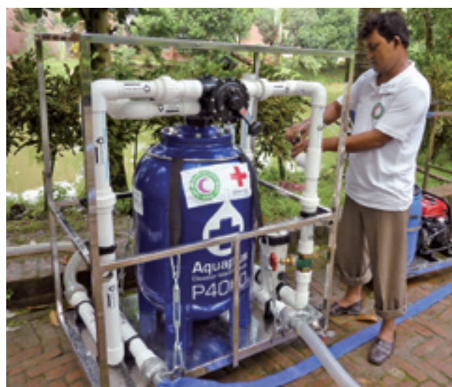
▲バングラデシュに配備された給水・衛生キット（浄水ユニット：1時間で4,000リットルの浄水が可能）© 日本赤十字社
